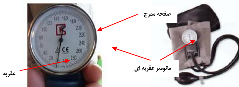
شکل ۷: دستگاه فشارسنج عقربه ای (aneroid monitor)
